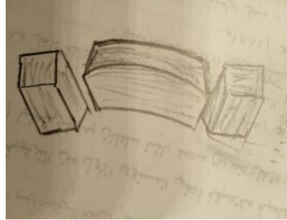
شكل (٨، ٩) أشكال الطوب الأجر والخشب المكون الأساسي للأعمدة الأجرية بوكالة الجداوي (عمل الباحث)
