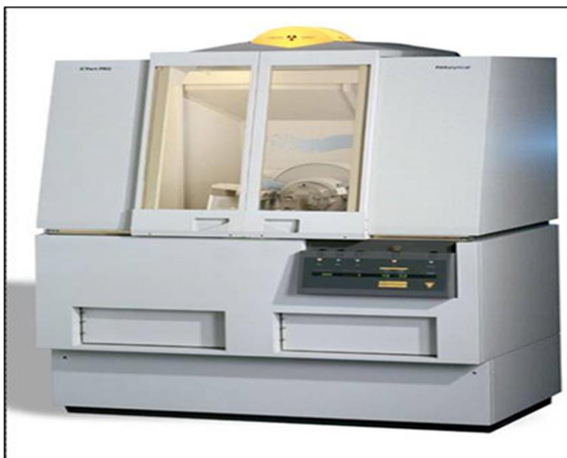
صورة رقم ٣ توضح جهاز حيود الأشعة السينية XRD المستخدم في تحليل عينة الطوب اللبن.
