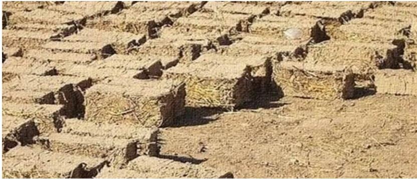
صورة رقم ٦ توضح تقنية صناعة الطوب اللبن.
