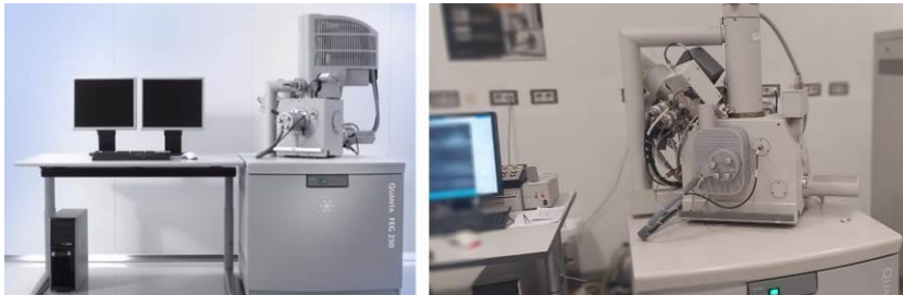
شكل رقم ٧ يوضح جهاز الميكروسكوب الإلكتروني الماسح المستخدم فى فحص و تحليل عينة الطوب اللبن
